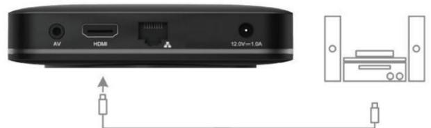
Verbinden Sie ein HDMI-Kabel mit dem HDMI-Ausgang der Amigo 7X und dem HDMI-Eingang Ihres A/V-Verstärkers oder Heimkinosystems.
